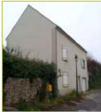
*Maisons insérées dans un talus avec rez-de-jardin à l'étage, et accès direct au garage depuis la rue : une adaptation intelligente du terrain, et la seule exception pertinente à l'interdiction de principe des garages enterrés.*
