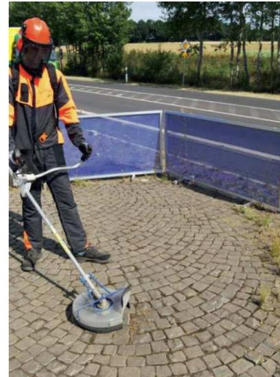
**Weed line : débroussailleuse avec cloche de protection**
